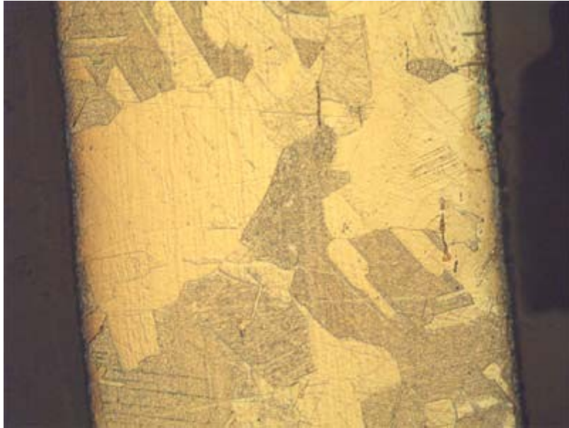
SLIKA 7: Mikrostruktura nerjaveče pločevine, ki je bila žarena na temperaturo 1050°C, v biopolju, pri 60-kratni povečavi. Kovina je dobila živost.
