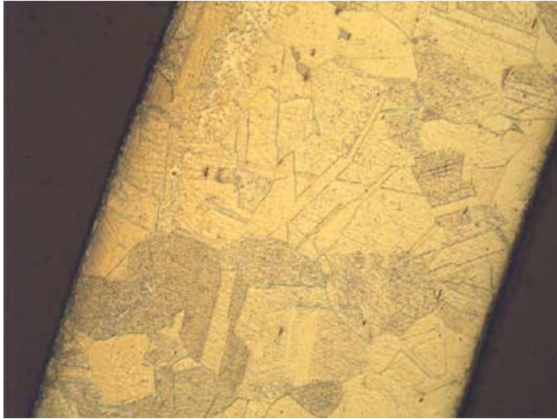
SLIKA 6: Mikrostruktura nerjaveče pločevine, ki je bila žarena na temperaturo 1050°C, v običajnih razmerah, pri 60-kratni povečavi. Kovina nima živosti.
